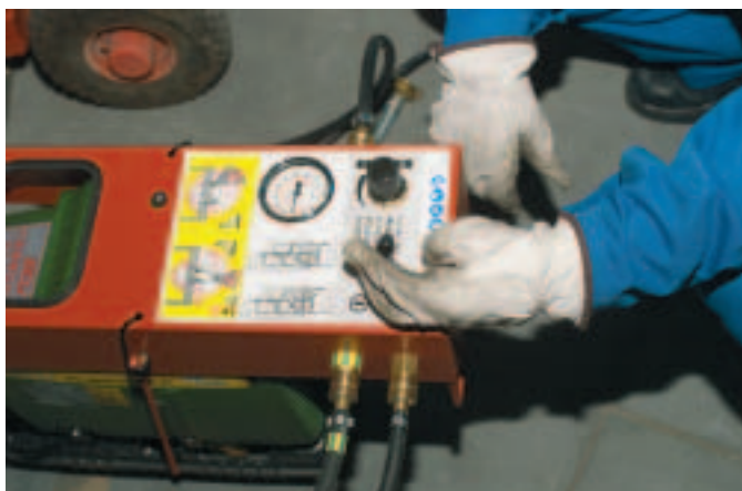
Betjening af fremføringsventilen.
