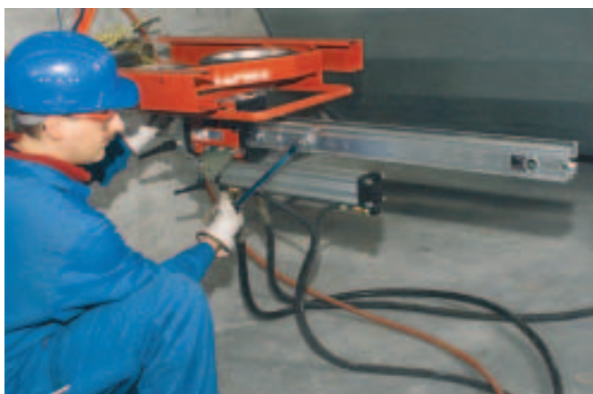
Kom forlængeren på forbindelseskonusen og fastgør den med excenterbolten.
