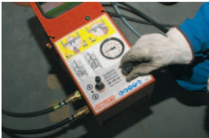
Indstilling af fremføringstrykket.
