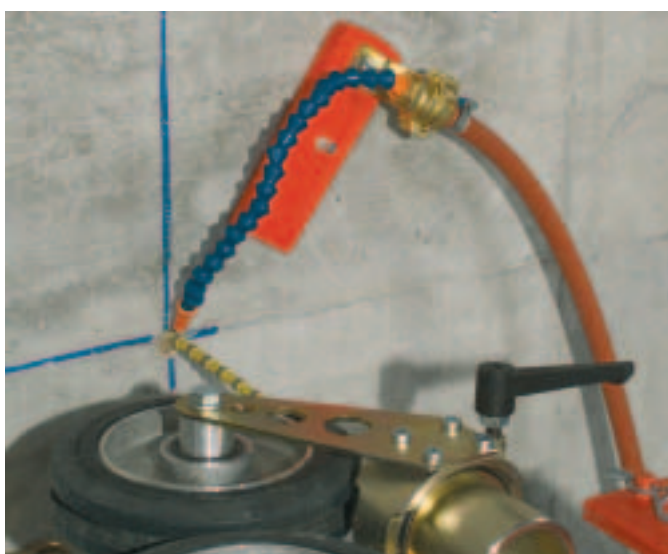
Montér mundstykket (til det kølende vand)
