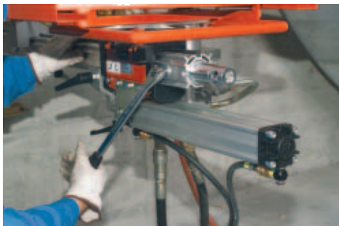
Monter forbindelseskonusen og fastgør den med excenterbolten.
