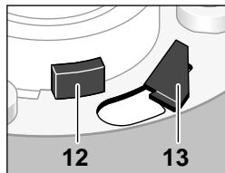
O disco abrasivo está correctamente fixo, quando os 3 pressores 13 e os 3 ressaltos 12 sobressaiam do cubo da chapa. O disco abrasivo deve poder girar-se livremente.
