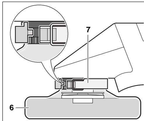
Draai de beschermkap 6 tegen de wijzers van de klok in de gewenste stand (werkstand).
