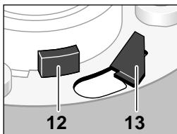
Hiomalaikka on oikein kiinnitetty, kun 3 pistintä **13** ja 3 nokkaa **12** ulottuvat peltikeskiön yli. Hiomalaikan täytyy pystyä pyörimään vapaasti.
