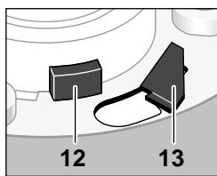
Il disco abrasivo è tesa correttamente quando i 3 pressori 13 e le 3 camme 12 sporgono oltre la scanalatura della lamiera. Il disco abrasivo deve poter essere girato liberamente.
