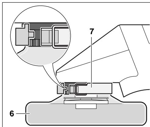
Ruotare la calotta di protezione 6 in senso antiorario e portarla alla posizione necessaria (posizione di lavoro).
