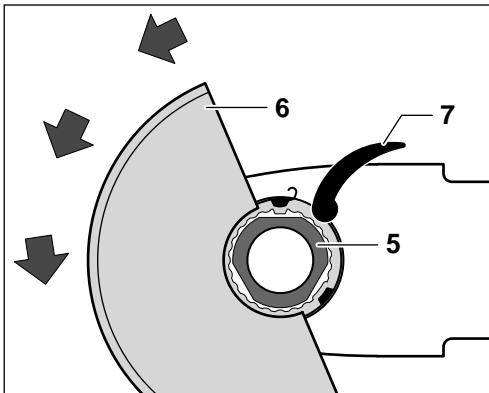
Tryck upp sprängskyddet på spindelhalsen tills skyddets ansats ligger mot maskinens fläns och kodnockarna griper in i runtomspåret på spindelhalsen.
