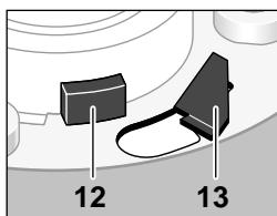
3 düşük seviye tutucusu **13** ve 3 tırnak **12** göbekten dışarı çıkıyorsa taşlama diskı doğru sıkılmış demektir. Taşlama diskı hiçbir yere sürtünmeden rahatça dönmelidir.
