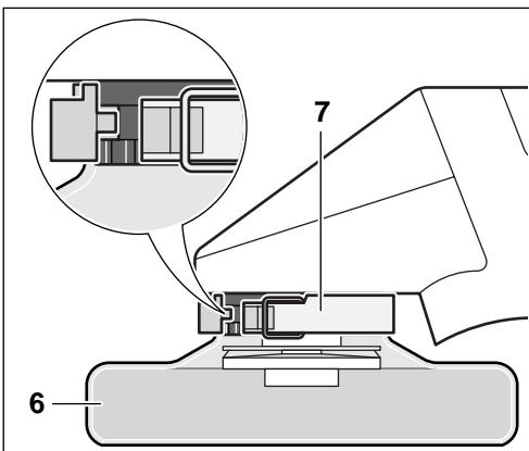
Kierrä laikkasuojus 6 vastapäivään haluttuun asentoon (työasentoon).
