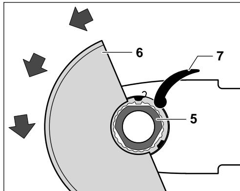
Applicare la calotta di protezione premendola sul collare alberino fino a far poggiare il collare della calotta di protezione sulla flangia della macchina e le camme codificatrici fanno presa nella scannalatura rotante del collare alberino.
