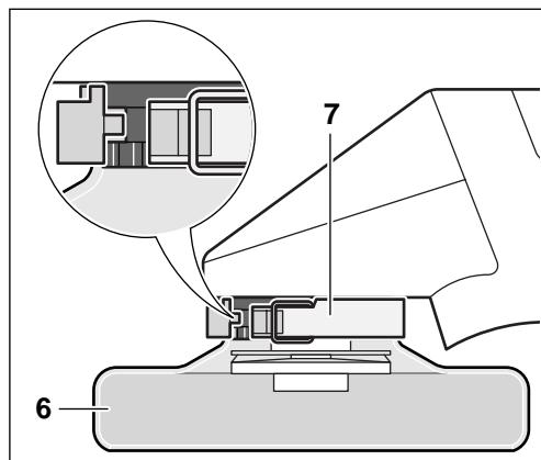
Die Schutzhaube 6 entgegen dem Uhrzeigersinn in die erforderliche Stellung (Arbeitsposition) drehen.
