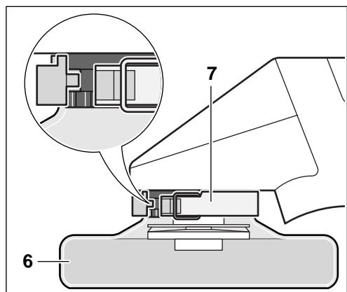
Tourner le capot de protection **6** dans le sens inverse des aiguilles d'une montre pour le mettre dans la position requise (position de travail).
