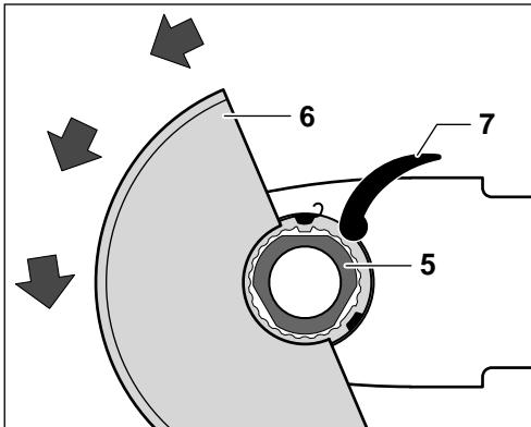
Trykk vernedekselet slik på spindelhalsen at kanten på vernedekselet ligger på flensen til maskinen og kodeknastene griper inn i noten på spindelhalsen.
