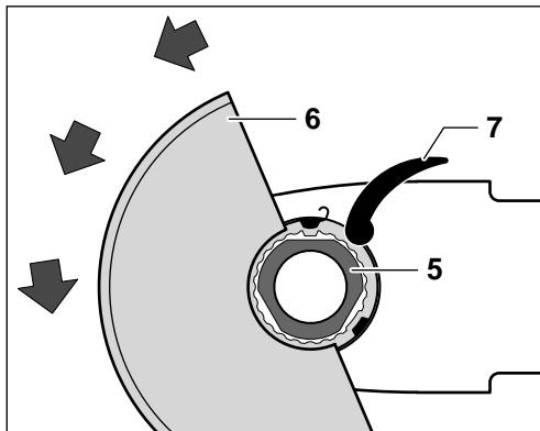
Pressionar a capa de protecção sobre a garganta do fuso, até que o colar da capa de protecção esteja apoiado na flange do aparelho e os ressaltos de codificação engatem na ranhura da garganta do fuso.
