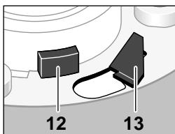
Slipskivan är korrekt spänd när de 3 nedhållarna **13** och de 3 nockarna **12** står ut över plåtnaven. Slipskivan måste kunna rotera fritt.
