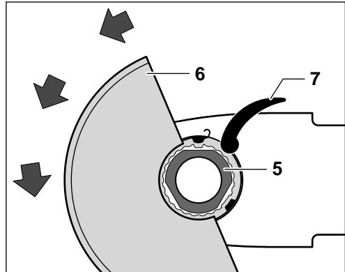
Monter le capot de protection sur le col de la broche en exerçant une pression jusqu'à ce que l'épaulement du capot de protection repose sur le flasque de l'appareil et que les cames de codage prennent dans la rainure périphérique du col de la broche.
