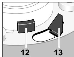
El disco de amolar está correctamente sujetado si las 3 piezas de apriete **13** y los 3 resalte de sujeción **12** llegan a sobresalir del buje de chapa. El disco de amolar debe girar libremente.
