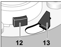
La meule est correctement serrée lorsque les 3 cames de retenue 13 et les 3 cames 12 dépassent le moyeu. La meule doit pouvoir tourner librement.
