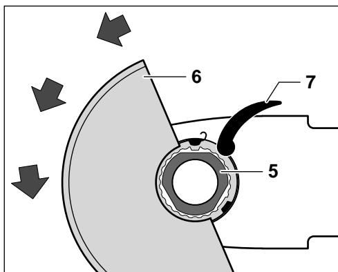
Die Schutzhaube auf den Spindelhals aufdrücken bis der Bund der Schutzhaube am Flansch des Gerätes aufsitzt und die Codiernocken in die umlaufende Nut am Spindelhals greifen.
