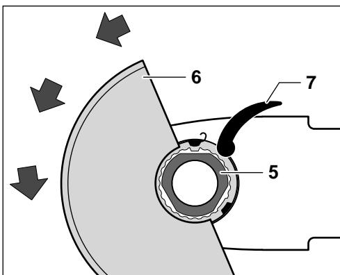
Tryk beskyttelsesskærmen fast på spindelhalsen, til kanten på beskyttelsesskærmen hviler på maskinens flange og kodelåsene griber ind i den omløbende not på spindelhalsen.
