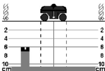
Painamalla mittauksen aikana painiketta **"mode" 8**, voidaan mittaustulosten osoitus kasvattaa 10 cm syvyyteen. Tämä on suositeltavaa erityisesti betonin ja muiden massiivisten seinämateriaalien kohdalla, joissa ei ole ilmaonteloita (kuten esim. kalkkihiekkakiviharkoissa).
