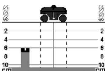
Ved å trykke på „mode“-tasten **8** i løpet av målingen kan anvisningen av måleresultatene utvides til en dybde på 10 cm. Dette anbefales spesielt for betong og andre massive veggmaterialer uten luftlommer (som f.eks. kalksandstein-massivblokker).
