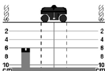
Genom att trycka på knappen **"mode" 8** under mätningen kan indikeringen av mätresultat utökas till 10 cm djup. Detta rekommenderas speciellt för betong och andra massiva väggmaterial utan luftslutningar (som t.ex. massivblock i kalksandsten).
