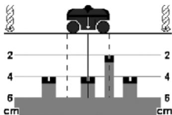
Esempio: Nella figura sono riconoscibili tre oggetti regolarmente disposti con una rispettiva profondità di foratura di 4 cm e la cui posizione e profondità fanno dedurre che si tratti di ferri di armature. Il quarto oggetto a 2 cm di profondità potrebbe p. es. essere un cavo di rete.
