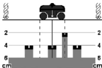
Exemple : dans la représentation ci-contre, il a été détecté à 4 cm de profondeur environ trois objets disposés régulièrement les uns par rapport aux autres. La position et la profondeur de ces objets laissent supposer qu'il s'agit de fers d'armature. Pour ce qui est du quatrième objet détecté à une profondeur de 2 cm, il s'agit sans doute d'une ligne électrique.
