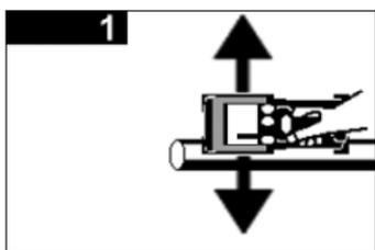
Seuls les objets disposés **perpendiculairement** à la direction de balayage sont détectés de manière fiable.
