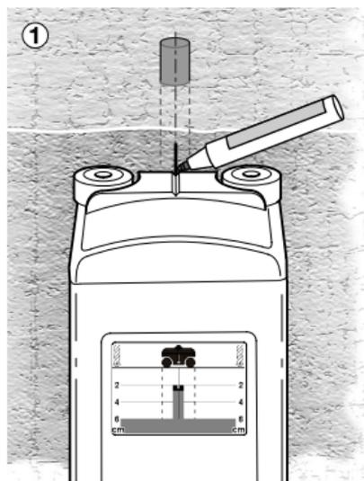
Per localizzare un oggetto, spostare lo strumento in direzione dello stesso fino a quando la linea centrale **g** dello strumento nel display arriva a trovarsi esattamente sopra la linea centrale **h** dell'oggetto trovato. L'oggetto si trova dunque precisamente sotto il centro dello strumento. Con l'aiuto dell'assistenza per allineamento **9** è possibile marcare la posizione dell'oggetto (Fig. ①).
