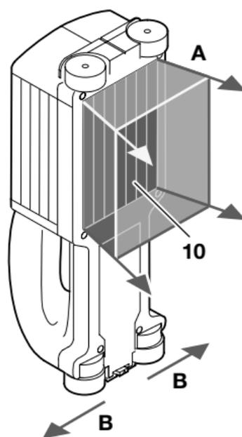
Tramite lo strumento si controlla la parte che si trova sotto il campo del sensore **10** in direzione di misurazione **A** fino alla massima profondità di misurazione. La misurazione può avvenire soltanto durante lo spostamento dello strumento in direzione di movimento **B** e con un minimo tratto di misura di 8 cm.
