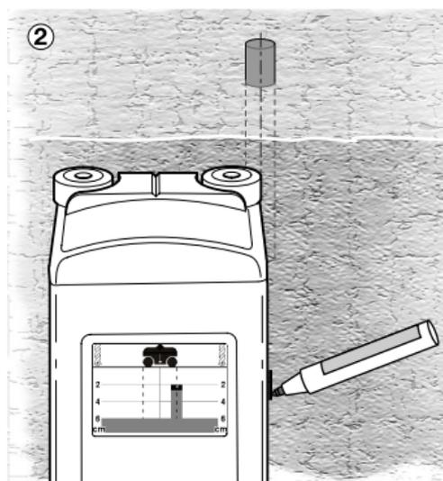
För lokalisering av ett objekt ska detektorn så länge köras i riktning mot objektet tills detektorns centrumlinje **g** på displayen ligger exakt över centrumlinjen **h** för hittat objekt. Objektet sitter nu exakt mitt under detektorn. Med inriktningshjälpen **9** kan objektets läge markeras (Bild ①).
