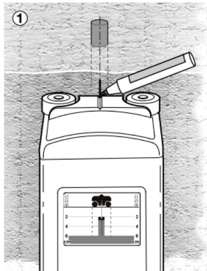
Para localizar um objecto, deverá movimentar o aparelho no sentido de marcha sobre o objecto, até que a linha central **g** do aparelho no display esteja exactamente sobre a linha central **h** do objecto detectado. O objecto se encontra exactamente sob o centro do aparelho. Com ajuda do auxílio de alinhamento **9** é possível marcar a posição do objecto (fig. ①).
