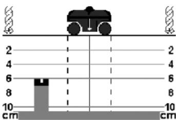
Pulsando la tecla **“mode” 8** durante la medición puede ampliarse la representación de la medición hasta una profundidad de 10 cm. Esta modalidad se recomienda especialmente en hormigón y demás materiales de construcción macizos poco porosos (como, p.ej., bloques macizos de arenisca calcárea).
