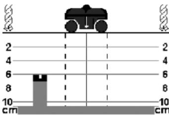
Door het indrukken van de knop „mode” 8 tijdens een meting kan de indicatie van de meetresultaten tot een diepte van 10 cm worden uitgebreid. Dit wordt in het bijzonder aangeraden bij beton en andere massieve muurmaterialen zonder luchtinsluitingen (zoals massieve kalkzandsteenblokken).
