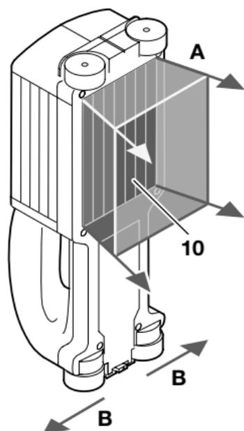
Mit dem Gerät wird der Untergrund des Sensorbereiches **10** in Messrichtung **A** bis zur maximalen Messtiefe überprüft. Die Messung ist nur während der Bewegung des Gerätes in Fahrtrichtung **B** und bei einer Mindestmessstrecke von 8 cm möglich.
