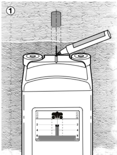
Zur Lokalisierung eines Objektes das Gerät so lange in Fahrtrichtung auf das Objekt zu bewegen, bis die Mittellinie **g** des Gerätes im Display genau über der Mittellinie **h** des gefundenen Objektes liegt. Das Objekt befindet sich dann genau unter der Mitte des Gerätes. Mit Hilfe der Ausrichthilfe **9** kann die Lage des Objektes markiert werden (Bild ①).
