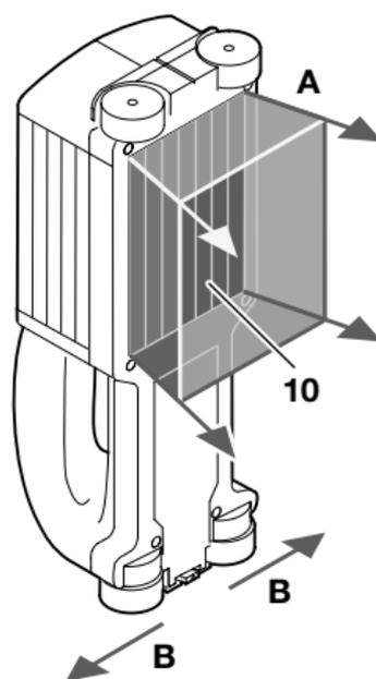
Com o aparelho é controlada a base da área do sensor **10** no sentido de medição **A** até a máxima profundidade de medição. A medição só é possível durante o movimento do aparelho na direcção de **B** e para uma distância mínima de medição de 8 cm.
