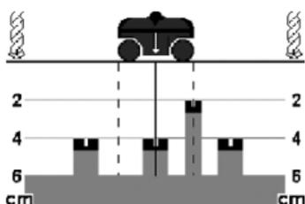
Eksempel: På bildet vises det tre regelmessig plasserte objekter med en tilhørende boreddybde på 4 cm, som med sin posisjon og dybde tyder på å være armeringsjern. Det fjerde objektet i en dybde på 2 cm kan f.eks. være en strømledning.
