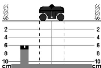
Με πάτημα του πλήκτρου „mode“ 8 κατά τη διάρκεια μια μέτρησης η ένδειξη μπορεί να επεκταθεί για μετρήσεις σε βάθη έως 10 cm. Η ρύθμιση αυτή συνιστάται ιδιαίτερα για μετρήσεις σε μπετόν ή άλλα συμπαγή υλικά τοιχοποιίας χωρίς εγκλείσματα αέρα (π.χ. συμπαγή μπλοκ από ασβεστόλιθο).
