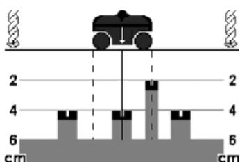
Eksempel: På billedet ses tre jævnt fordelte genstande i 4 cm dybde, der sandsynligvis er armeringsjern på grund af deres position og dybde. Ved den fjerde genstand i 2 cm dybde kan der måske være tale om f.eks. en netledning.
