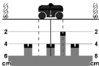
Exemplo: Na figura encontram-se três objectos regularmente dispostos com uma respectiva profundidade de perfuração de 4 cm, que devido à sua posição e profundidade permitem deduzir que se trata de aço de reforço. No quarto objecto numa profundidade de 2 cm, pode ser que p.ex. se trate de um cabo eléctrico.
