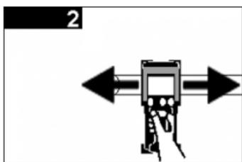
Únicamente son detectados de forma fiable aquellos objetos dispuestos **transversalmente** al sentido de movimiento del aparato.
