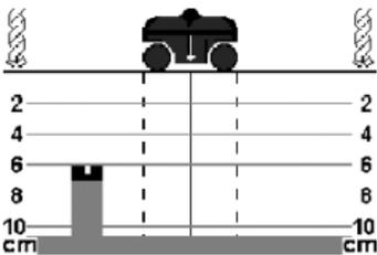
Ölçme işlemi sırasında "**mode**" düğmesine **8** basılmak suretiyle ölçme sonuçlarının gösterimi 10 cm'ye kadar derinleştirilebilir. Bu ayar özelliği; hava bağlantısı bulunmayan beton ve diğer masif duvar malzemelerinin ölçülmesi ve taranmasına uygundur (örneğin kireçli kum taşından yapılmış tuğlalarda örülmüş duvarlarda).
