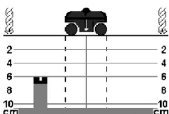
Ved at trykke på tasten „mode“ **8** under målingen kan visningen af måleresultaterne udvides til en dybde på 10 cm. Dette anbefales især ved beton og andre massive vægmateriale uden luftlommer (som f.eks. massive kalkstensblokke).
