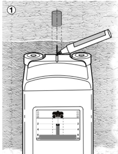
Pour localiser un objet, déplacer l'appareil au-dessus de l'objet dans la direction de balayage jusqu'à ce que sur l'afficheur la ligne médiane **g** de l'appareil coïncide avec la ligne médiane **h** de l'objet détecté. L'objet se situe alors exactement sous le milieu de l'appareil. Le trait de visée **9** permet à l'utilisateur de repérer la position de l'objet considéré (Fig. ①).
