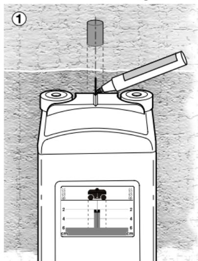
Para localizar un objeto, desplazar el aparato hacia éste hasta que la línea central **g** del aparato mostrada en el display coincida exactamente con la línea central **h** del objeto detectado. El objeto se encuentra entonces debajo del centro del aparato. La ayuda de alineación **9** permite marcar la posición del objeto (figura ①).
