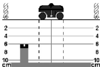
Le fait d'enfoncer la touche « **mode** » **8** pendant une mesure, permet d'étendre la profondeur d'affichage à 10 cm. Ce réglage s'avère souvent judicieux pour les parois de béton et autres parois en matériau massif sans inclusion d'air d'aucune sorte (parpaings massifs de grès argilo-calcaire, par exemple).
