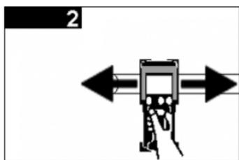
È possibile identificare con sicurezza esclusivamente oggetti che si trovano in posizione **trasversale** rispetto alla direzione di spostamento dello strumento.
