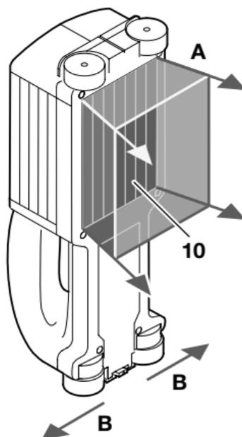
Laite tarkistaa tunnistinalueen **10** alustan mittaussuunnassa **A** suurimpaan mittaussyvyyteen asti. Mittaus on mahdollinen ainoastaan laitetta liikesuunnassa **B** siirrettäessä ja 8 cm:n vähimmäismittaamatkalla.
