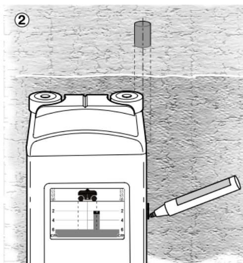
Til lokalisering av et objekt beveges apparatet så lenge i retning objektet til apparatets midtlinje **g** på displayet ligger nøyaktig over midtlinjen **h** til det funnede objektet. Objektet befinner seg da nøyaktig under midten av apparatet. Ved hjelp av opprettingshjelpen **9** kan objektets posisjon markeres (bilde ①).
