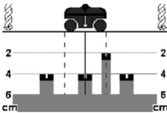
Voorbeeld: In de afbeelding zijn drie regelmatig geplaatste voorwerpen met een bijbehorende boordiepte van 4 cm herkenbaar, die door hun plaats en diepte aan betonwapening doen denken. Het vierde voorwerp op een diepte van 2 cm kan bijvoorbeeld een netleiding zijn.
