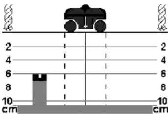
Durch Drücken der Taste „**mode**“ **8** während einer Messung kann die Anzeige der Messergebnisse auf 10 cm Tiefe erweitert werden. Dies empfiehlt sich besonders bei Beton und anderen massiven Wandmaterialien ohne Lufteinschlüsse (wie z. B. Kalksandstein-Vollblock).
