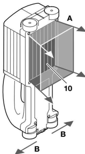
Med detektorn undersöks området under sensorn **10** i mätriktning **A** ned till maximalt mätdjup. Mätning kan utföras endast när detektorn körs i rörelseriktningen **B** och över en sträcka på minst 8 cm.
