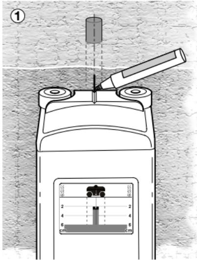
Beweeg voor het lokaliseren van een object het gereedschap zo lang in de verplaatsingsrichting naar het object tot de middellijn **g** van het gereedschap in het display precies boven de middellijn **h** van het gevonden object ligt. Het object bevindt zich dan precies onder het midden van het gereedschap. Met de uitlijnhelp **9** kan de plaats van het object worden gemarkeerd (afb. ①).
