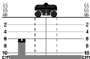
Pressionando a tecla **“mode” 8** durante uma medição, é possível ampliar a indicação dos resultados de medição até uma profundidade de 10 cm. Isto é principalmente recomendável para betão e outros materiais de parede maciços sem cavidades com ar (como p.ex. blocos de areia calcária).
