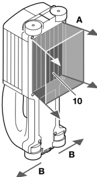
Bu cihazla, sensör alanı **10** altındaki zemin **A** ölçme yönünde maksimum ölçme derinliğine kadar taranır ve kontrol edilir. Ölçme işlemi ancak cihazın **B** hareket yönünde hareketi halinde ve 8 cm'lik minimum ölçme mesafesinde mümkündür.
