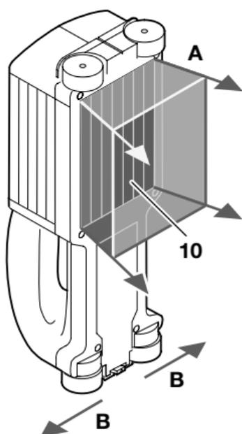
Με τη συσκευή ελέγχεται το υπόστρωμα της περιοχής των αισθητήρων **10**, έως το μέγιστο δυνατό βάθος μέτρησης, με κατεύθυνση μέτρησης **A**. Η μέτρηση είναι δυνατή μόνο όταν η συσκευή μετακινείται με τη φορά **B**. Η ελάχιστη διαδρομή μέτρησης ανέρχεται σε 8 cm.
