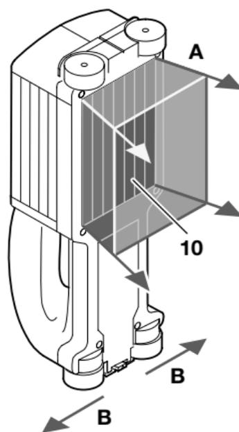
El aparato explora el material base dentro del área del sensor **10** en el sentido de medición **A** hasta la profundidad de captación máxima. Solamente se realiza la medición, si el aparato se desplaza en el sentido **B** cubriendo un tramo de medición mínimo de 8 cm.
