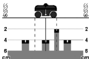
Exempel: På bilden kan tre regelbundet placerade objekt med respektive borrhjup på 4 cm identifieras, som med hänsyn till läge och djup kan antas vara armeringsjärn. Fjärde objektet på 2 cm djup kan t.ex. vara en nätledning.
