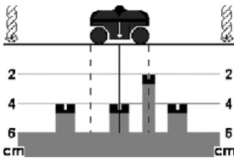
Beispiel: Im Bild sind drei regelmäßig angeordnete Objekte mit einer zugehörigen Bohrtiefe von 4 cm Tiefe erkennbar, die durch ihre Lage und Tiefe auf Armierungseisen schließen lassen. Beim vierten Objekt in 2 cm Tiefe kann es sich z.B. um eine Netzleitung handeln.
