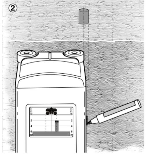
Bir nesneyi lokalize etmek için cihazı hareket yönünde ve nesne üstünde cihazın orta hattı **g** Display'de tam olarak bulunan nesnenin orta hattı **h** üzerine gelinceye kadar hareket ettirin. Bu durumda nesne cihazın tam ortasının altında bulunur. Doğrultma yardımcısı **9** ile nesnenin konumu işaretlenebilir (Şekil ①).
