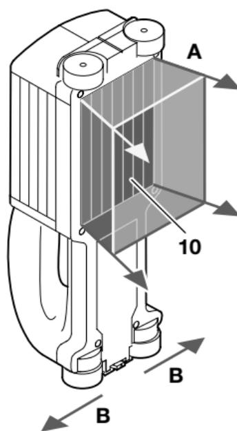
Med apparatet kontrolleres undergrunnen til sensorområdet **10** i måleretning **A** frem til maksimal måledybde. Målingen er kun mulig mens apparatet beveges i retning **B** og ved en minimum-målestrekning på 8 cm.
