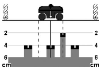
Ejemplo: En la figura se representan tres objetos equidistantes situados a una profundidad de 4 cm, que por su posición y profundidad, permiten deducir que se trate de acero para armar. El cuarto objeto se halla a una profundidad de 2 cm y pudiera ser, p.ej., un cable de red.
