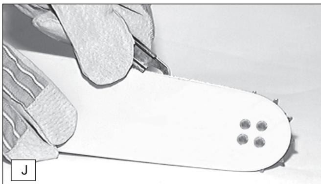
Die Laufflächen der Sägeschiene sind regelmäßig auf Beschädigungen zu überprüfen und mit geeignetem Werkzeug zu reinigen.
