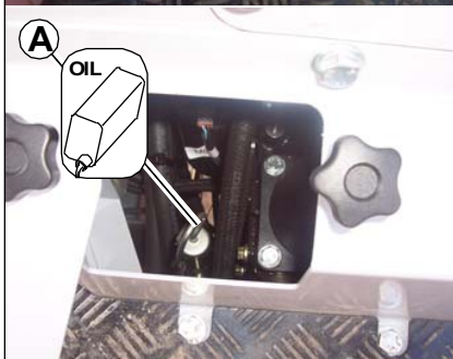
Fig. 58: Oliemålepind og oliedæksel med kabine
