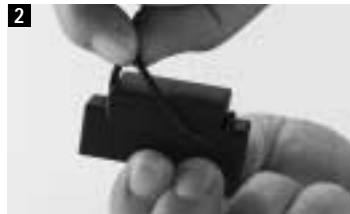
2 Montér en ny gummi O-ring på slagstykket som vist.
