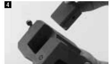
4 Sæt låsestykket i prægehovedet og stram låseskruen (M6×30) med en unbraconøgle.
