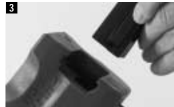
3 Montér dæmperen på slagstykket og før begge dele ind i prægehovedet som vist.
