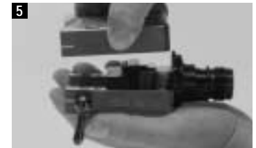
Sæt husets to halvdele sammen og skru de 4 skruer M6x30 i vha. Loctite og en unbrac-nøgle.
