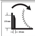
Rotationsrichtung des Abstandshalters für die Zugvorrichtung zum Sägen breiter Profilleisten.
