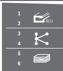
V tabuľke je uvedený odporúčaný stupeň otáčok v závislosti od obrábaného materiálu: pre hliník, plast, drevo.
