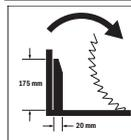
Direção de rotação do distanciador para o dispositivo de tração para serrar barras perfiladas mais largas.
