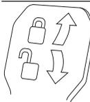
**Kiristysvipu kiinni:** sahausvarrelle säädetty pystysuuntainen jiirikulma pysyy paikallaan.
