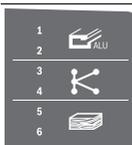
Die Tabelle zeigt die empfohlene Drehzahlstufe in Abhängigkeit vom zu bearbeitenden Werkstoff: Aluminium, Kunststoff, Holz.
