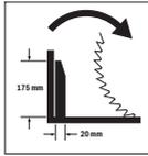
Dirección de rotación del distanciador del dispositivo de tracción para serrar molduras perfiladas anchas.
