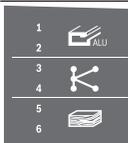
Le tableau indique la position de vitesse recommandée en fonction du matériau à couper : aluminium, plastique, bois.
