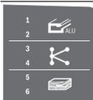
Ο πίνακας δείχνει τη συνιστώμενη βαθμίδα αριθμού στροφών ανάλογα με το επεξεργαζόμενο υλικό: Αλουμίνιο, συνθετικό υλικό, ξύλο.
