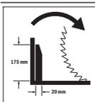
Rotasjonsretning, avstandsholder for uttrekksanordning til bruk ved saging av brede profillister.
