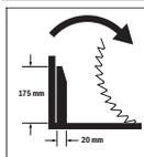
Φορά περιστροφής του αποστάτη για τη διάταξη έλξης για το πριόνισμα πλατιών μεταλλικών προφίλ.
