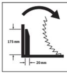
Direcția de rotație a distanțierului dispozitivului de tracțiune pentru tăierea șipcilor profilate late.
