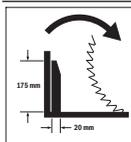
Направление вращения распорного элемента тягового устройства для пиления широких профильных реек.
