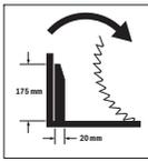
A húzószerszám számára szolgáló távtartó forgásiránya széles profillécek fűrészeléséhez.
