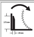
Посока на въртене на разделителя за изтеглящо съоръжение за срязване на широки профилни дъски.
