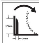
Smjer okretanja odstojnog graničnika vučne naprave za rezanje širokih profilnih letvica.
