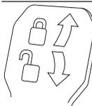
**Зажимной рычаг зажат:** настроенное на кронштейне значение вертикального угла распил сохраняется.
