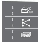
Таблицата показва препоръчителната скорост на въртене в зависимост от обработвания материал: алуминий, пластмаса, дърво.
