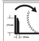
Kierunek obrotu elementu dystansowego mechanizmu przesuwu do cięcia szerokich listew profilowych.
