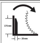
Avståndshållarens rotationsriktning för draganordningen för sågning av breda profillister.
