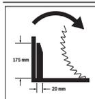
Rotationsretningen af afstandsholderen til trækanordningen ved savning af brede profillister.
