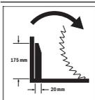
Smer rotacije držača razmaka za vučni mehanizam za testerisanje širokih kalupa.
