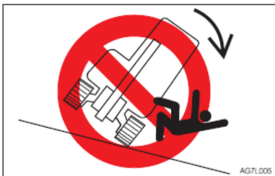
Kørsel vandret på skråninger
