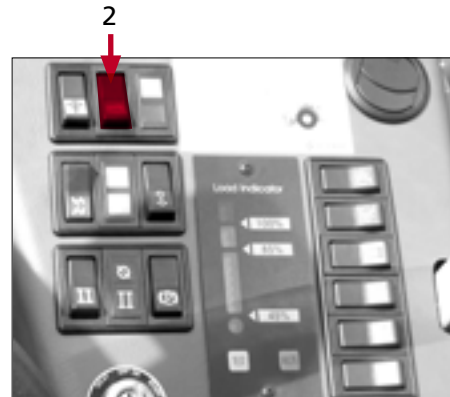
Fig. - 55 Kontakt til el-stikdåse på løftestellet
