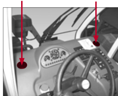
Fig. - 29 Ventilationsdyser - forrude
