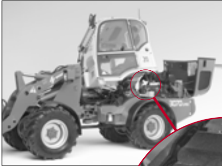
Fig. - 74 Sikringsstøtte til førerplads
