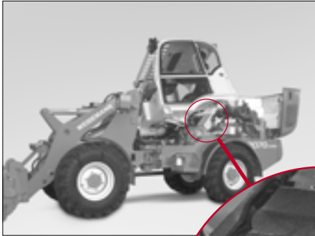
Fig. - 74 Sikringsstøtte til førerplads
