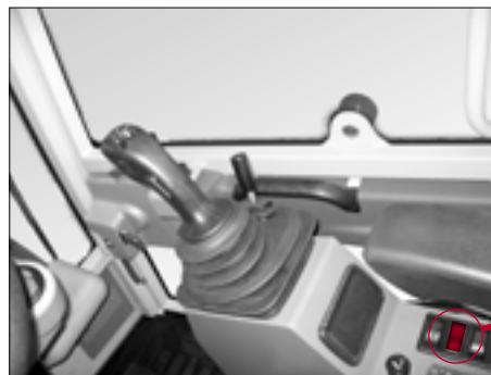
Fig. - 66 Nødsænkning af løftestellet
