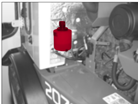
Fig. - 27 Sprinkleranlægs- beholderens placering
