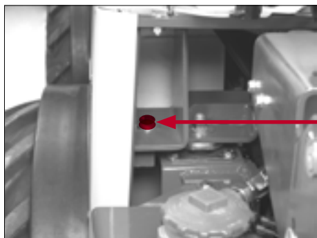
Fig. - 59 Fastspændings- bolt bag til førerplads
