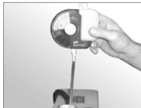
Fig. - 69 Kontrol af frostbeskyttelsesblanding
