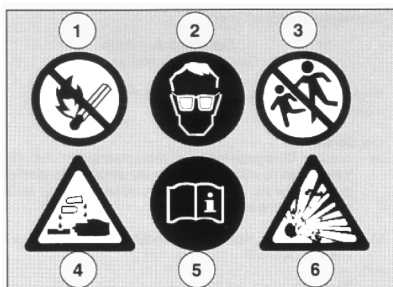
Advarselsmærkat på batteri
