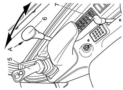
**ADVARSEL!** Hvis planeringskærret er bagved (drejning med 180 grader), skal køredrevet betjenes omvendt.
