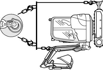
Til løftning af maskinen skal de der til beregnete antulningspunkter anvendes, se illustrationen.
